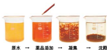
薬品で「きれいな水」に処理する設備
