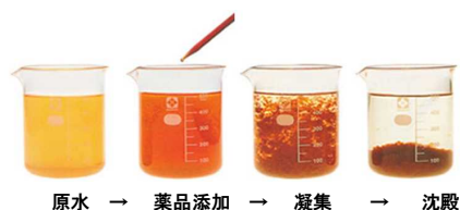
薬品で「きれいな水」に処理する設備
