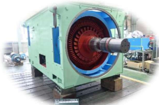
発電機復旧工事
